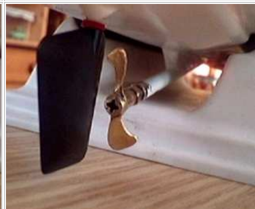
NR6 Z-D31-2FS Z-Schraube 2 Flügel schmal D31mm
