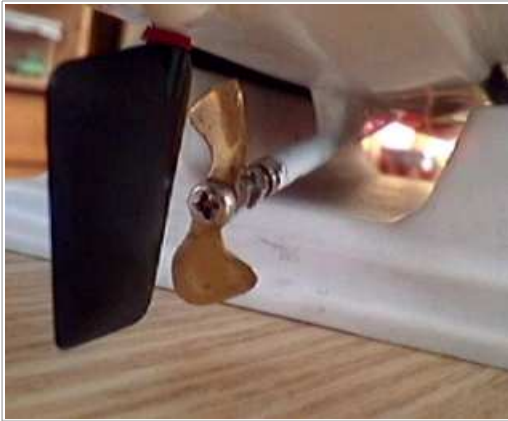
NR10 Z-D32-2FB Z-Schraube 2 Flügel breit D32 mm
