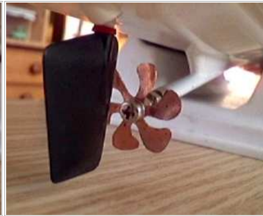
NR2 Z-D28-6F Z-Schraube 6 Flügel D28 mm
