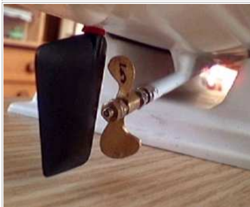
NR5 Z-D31-2FB Z-Schraube 2 Flügel breit D31 mm
