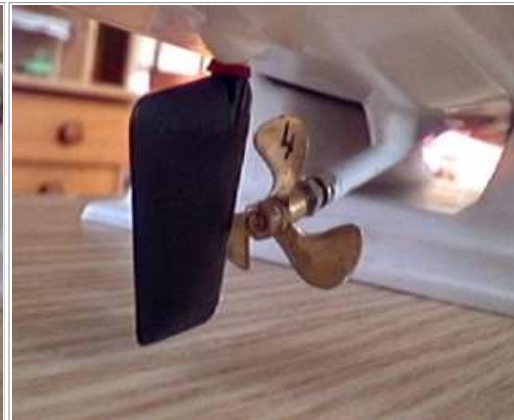
NR4 Z-D31-3FB Z-Schraube 3 Flügel breit D31 mm
