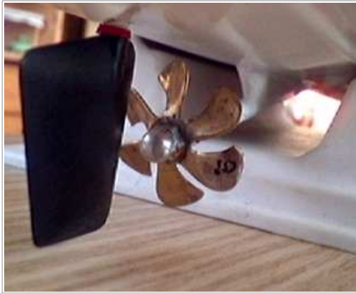
NR9 Z-D34-6F Z-Schraube 6 Flügel D34 mm
