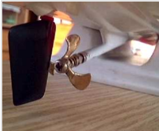
NR3 Z-D31-3FS Z-Schraube 3 Flügel schmal D31 mm
