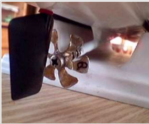
NR8 Z-D30-6F Z-Schraube 6 Flügel D30 mm
